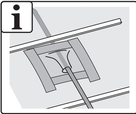
D Dachdurchführungen müssen systemgerecht und wasserdicht mit dem Unterdach verbunden werden.
