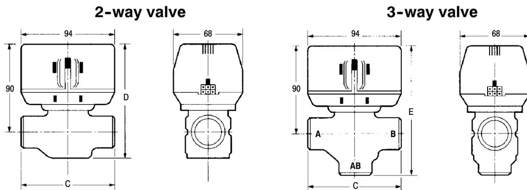
Fig. 9. Valve dimensions
