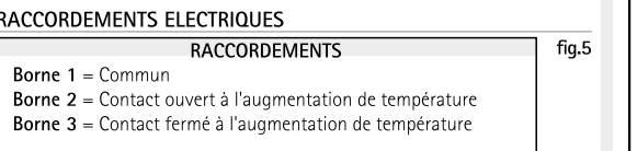
En règle générale (installation de chauffage), on utilise les bornes 1 et 2.
